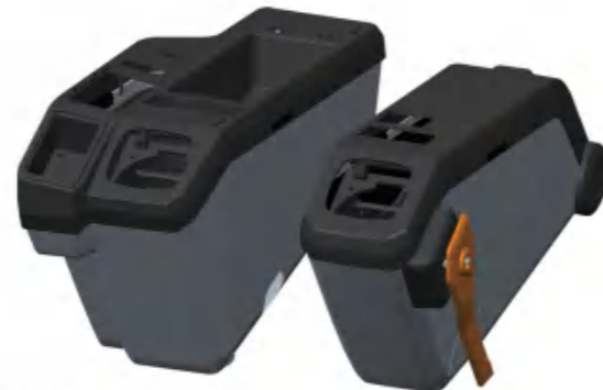
FSX-512 左箱外形尺寸: 580x170x330 (长x宽x高) 安装部件: 锁止开关、翘板开关 右箱外形尺寸: 620x202x330 (长x宽x高) 安装部件: 集成开关面板、启动锁、备用电源、杂物盒等
