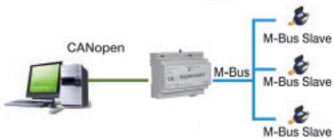
模块可以作为M-Bus主站寻址M-Bus从站，也可以作为从站集成到现有网络中。除了网关功能外，一些M-Bus总线网关还配有扫描仪。
