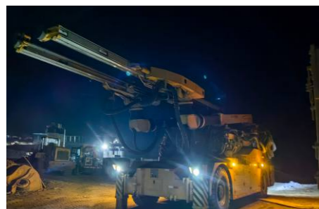
双折叠臂，适用隧道台阶法施工 (上中下台阶作业)
