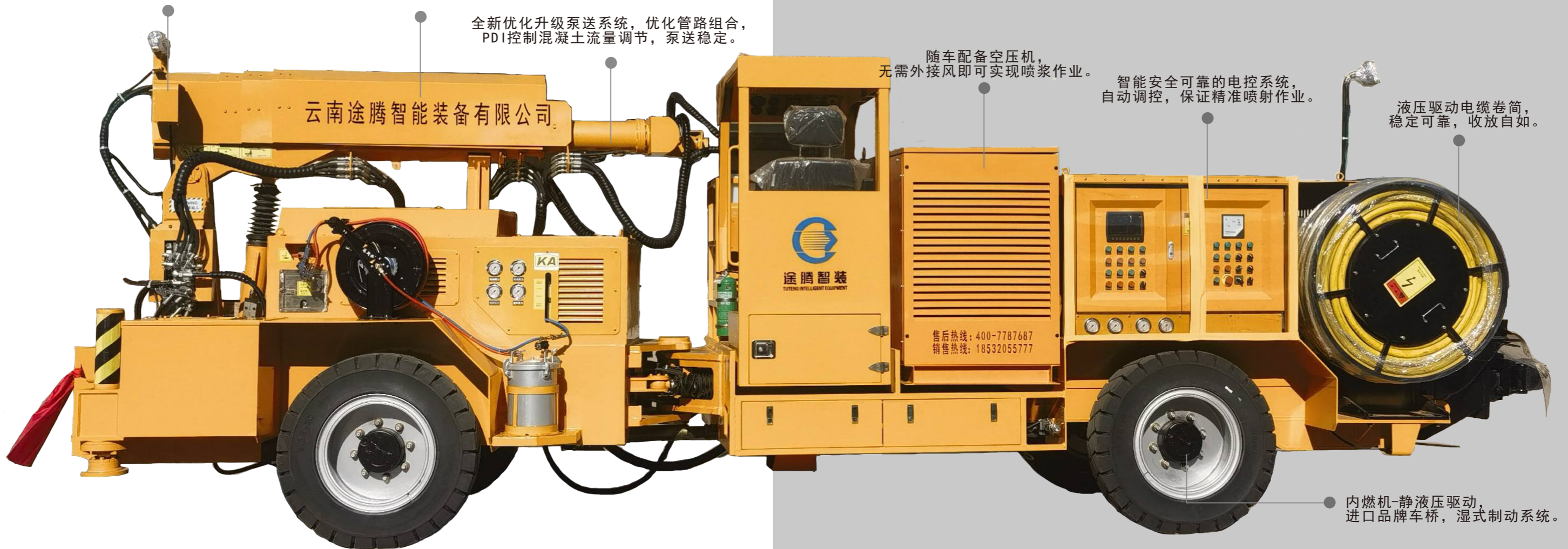
臂架采用四节臂，三级伸缩的结构设计，结构小巧，动作灵活。
