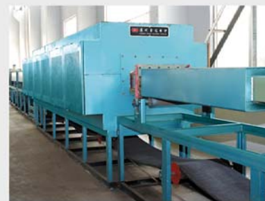
无氧化退火炉 Non-oxidation bright anneal furnace
