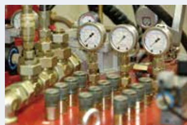
压力表和测压线
