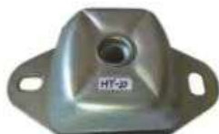
减震胶 孔18厘 下长外径230*方外径110*高72
