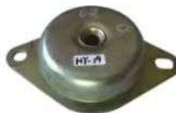
减震胶 孔14厘 圆外径102*下长外径176*高40
