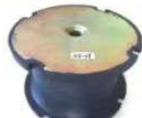
减震胶 外径165*高100 螺丝18厘
