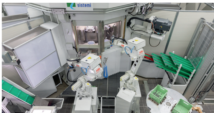
全自动化西德福管路连接件生产设备
