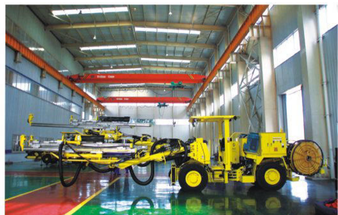
CYTJ76A2掘进钻车装配下线
