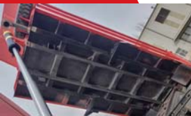
底板衬套结构，防开焊
