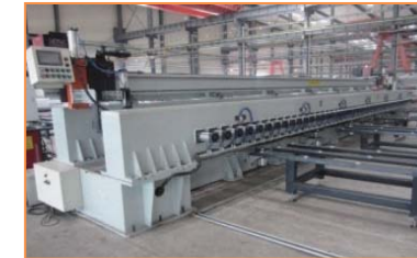
9.5米拼版纵缝焊接机 焊接质量水平国内最高
