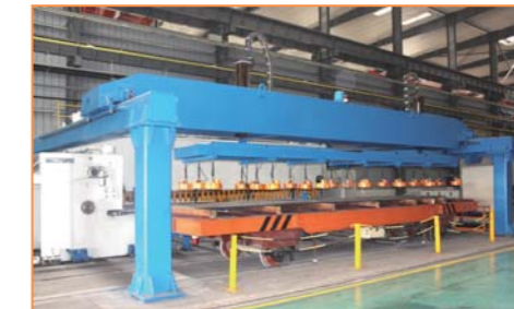
9M*16mm全数控剪切自动加工中心加工精度高、成形好
