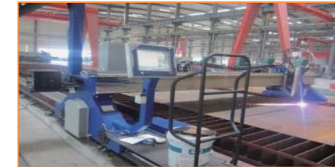
德国梅塞尔130精细等离子切割机切割精度更强
